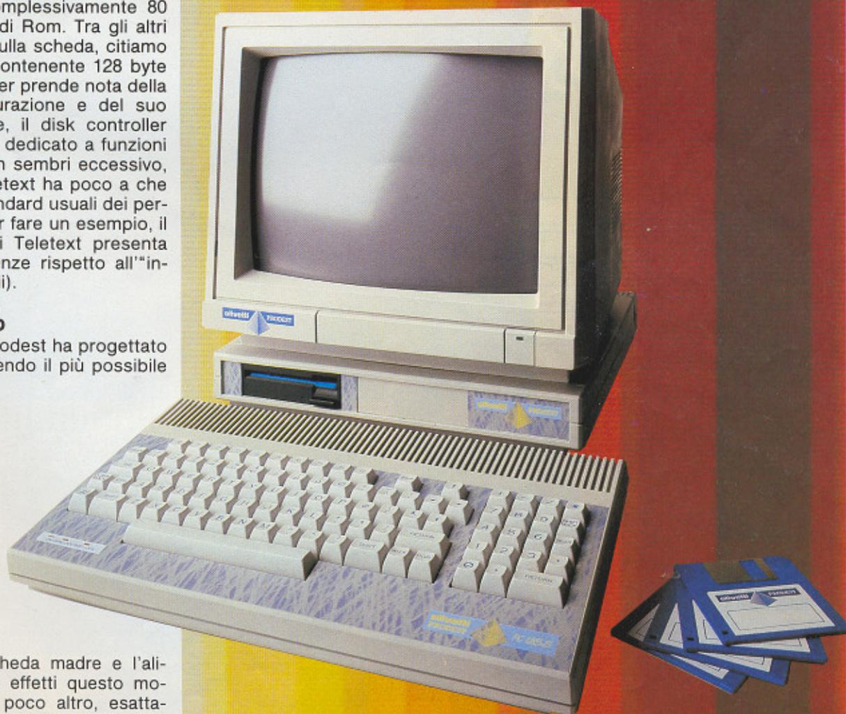
staccate la scheda madre e l'alimentazione. In effetti questo modulo contiene poco altro, esattamente il drive di serie e quello opzionale. I dischetti usati sono da 3.5 pollici, e hanno una capacità (formattati) di 640 Kbyte. Pur trattandosi di un dato insolito per questo formato, il sistema di registra-
